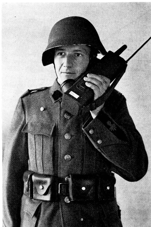
Abb. 43. Klein-Funkgerät «Handy talkie».
