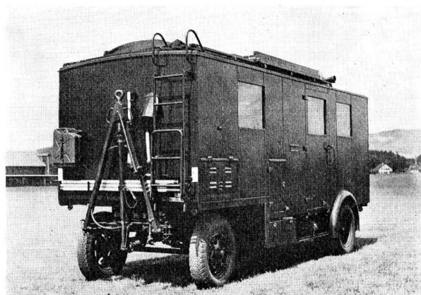
Abb. 40. Zweiachs-Kastenanhänger zur Unterbringung von Feldzentralen und Fernschreibstationen. Modell 1948.
