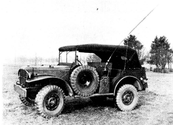
Abb. 45. Funkstation Fix in «Kommando Car» eingebaut, 10 Kanäle, kristallgesteuert.
