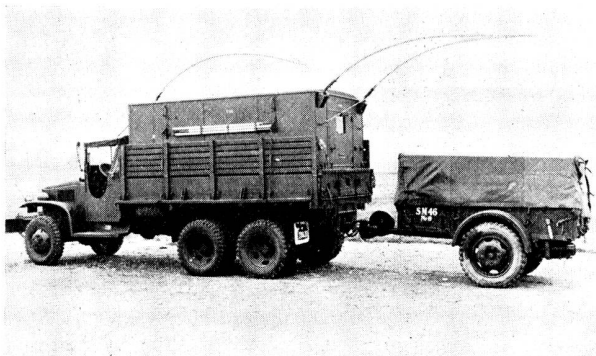
Abb. 41. Funkstation SM 46 auf geländegängigem Lastwagen montiert.
