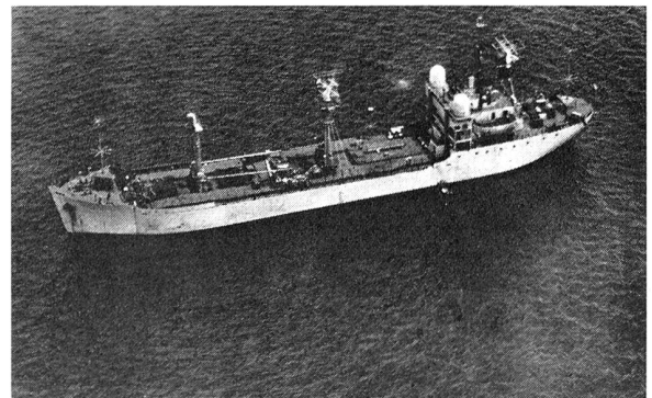
Das Bahnverfolgungsschiff «Rose Knot» dient als mobile Telemetriestation für Versuche mit bemannten Raumfahrzeugen. Seine Ausrüstung erlaubt Empfang und Befehlsübertragung.
