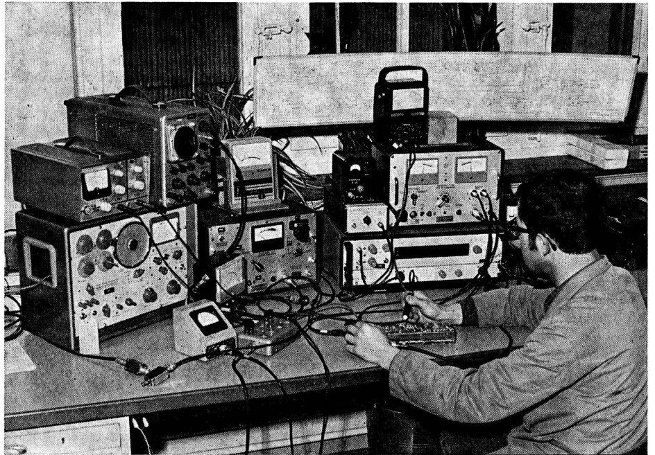
Messplatz, zusammengestellt aus Einzelmessgeräten
