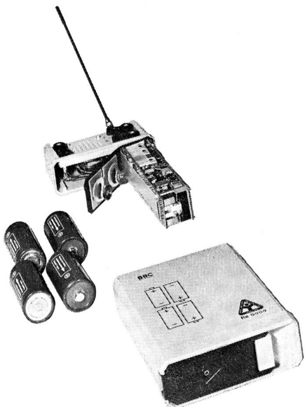
Bild 8: Innenansicht des Schutzraumpempfängers
