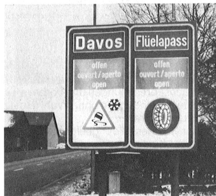
Bild 4: Das Doppel-Wechselsignal in Landquart, konstruiert nach dem Bandprinzip Double signal à information interchangeable placé à Landquart selon le principe d'impression sur bandes plastifiées (Kantonspolizei Graubünden)
