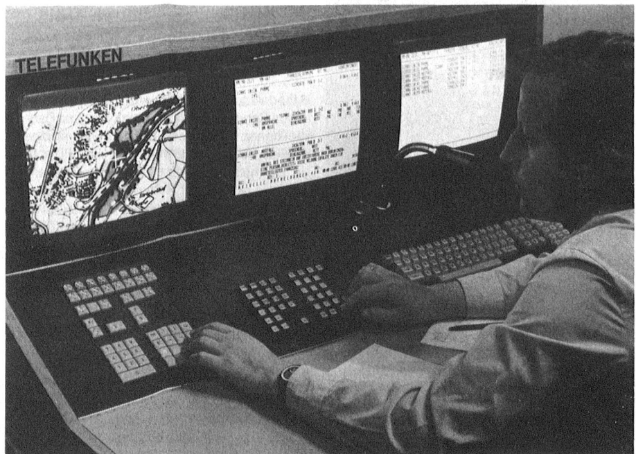
In einer Rettungsleitstelle werden die Notrufe des Auto-Notfunk-Systems empfangen und der Standort des notrufenden Fahrzeuges automatisch auf einer Landkarte angezeigt.
