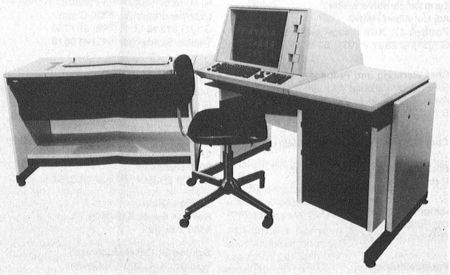
La Vydec 4000: écran double (48 cm), affichage de 160 caractères par ligne, 6000 caractères à la fois. Clavier Langage Naturel.
