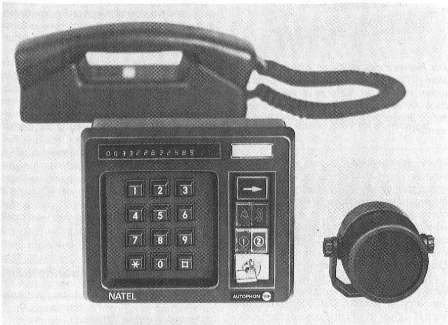
Das neue NATEL-Bedienungsgerät ist mit einem Nummernspeicher und einem Display ausgestattet. Im Bild sind auch die beiden andern Bedienelemente (Mikrotelefon und Lautsprecher) zu sehen.
