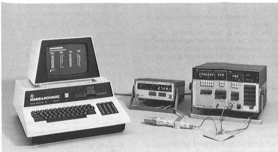
Der Process Controller PPC von Rohde & Schwarz ist ein Tischrechner, der alle Eigenschaften aufweist, die für normgerechte IEC-Bus-Steuerung sowie für schnelle und bequeme Bedienung erforderlich sind. (Bild Rohde & Schwarz)
