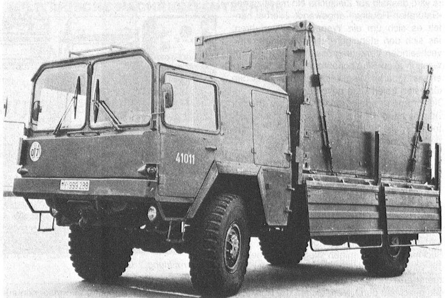
Teilnehmer im AUTOKO-Netz (Knotenvermittlung in Kabine, verlastet auf Lkw 4 t) Centre de commutation mobile monté sur camion 4 tonnes
