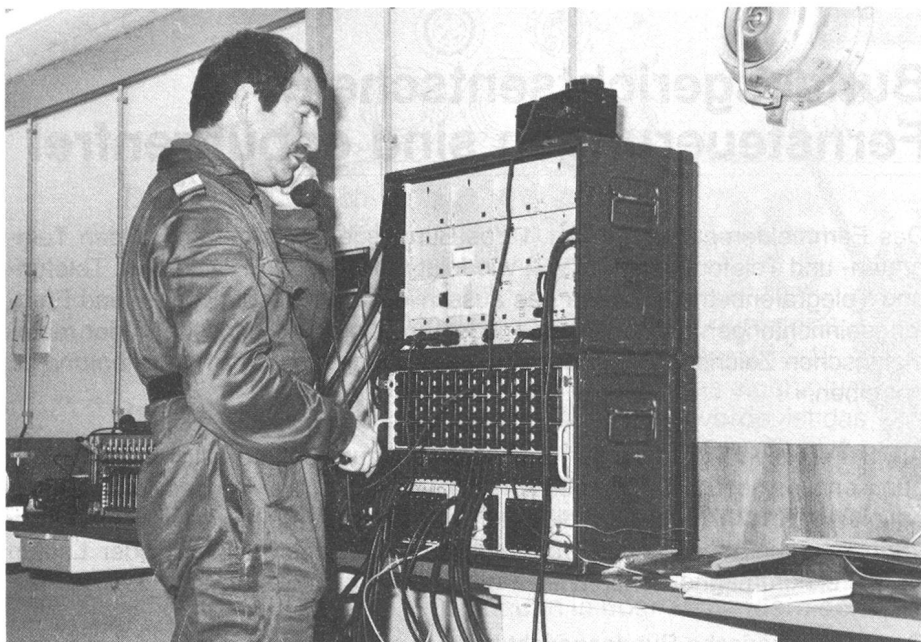
Das Bild zeigt einen Mehrkanalteil MK 5/4 im KP Schaffhausen. – Auch die Sektion Schaffhausen benützte als Tenue das militärische Combi.
