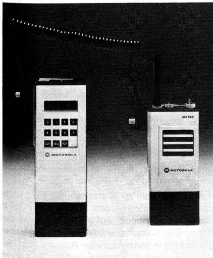
Handfunkgerät MX 330 mit DVP und Codiergerät beim Einlesen des Codes.
