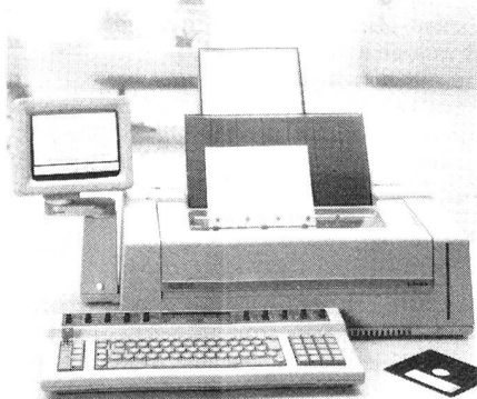
Die Textstation T 4200 von Siemens-Albis AG besteht aus dem Typenradrunder und Elektronik in einem Tischgehäuse sowie angefügtem Bildschirm und frei beweglicher Tastatur.
