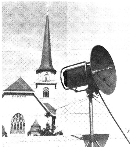
Die drei Ostschweizer Sektionen Mittelheintal, Thurgau und St. Gallen–Appenzell schalteten eine mustergültige Kleinrichtstrahlverbindung über 3 Relaisstationen. Unser Bild zeigt den Endpunkt R-902 in St. Margrethen.
