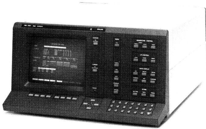
Der neue Logikanalysator PM 3551 von Philips ist dank festverdrahteten Tasten (Softkeys) einfach zu bedienen.
