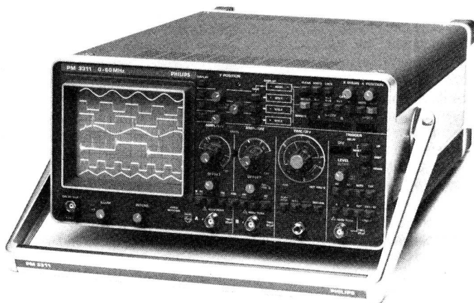
Das Speicheroszilloskop PM 3311 von Philips arbeitet mit einer Abtastrate von 125 MHz und hält damit den «Weltrekord».
