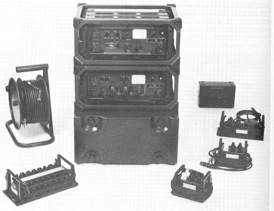
Mit der neuen Mehrkanalausrüstung MK-7 kann die Kapazität der Richtstrahlverbindungen verdoppelt werden. (Bild: BAUEM)
