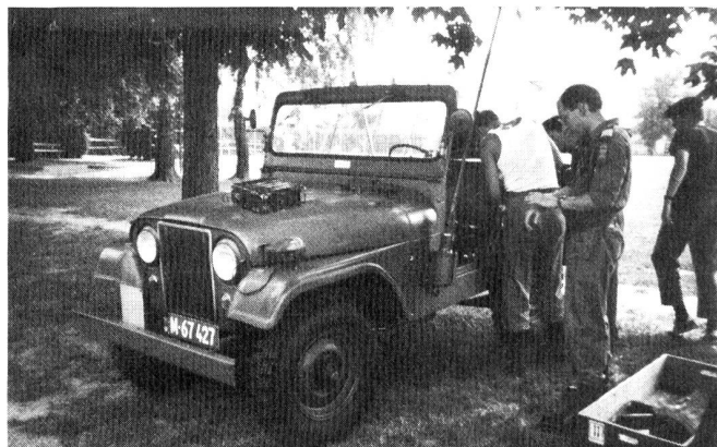
Fachtech Kurs SE-227: Bevor am Nachmittag die Instruktionen erteilt werden, üben die Kurslehrer selbst noch einmal am Objekt. Hier der Einbau des SE-227 in einen Jeep.
