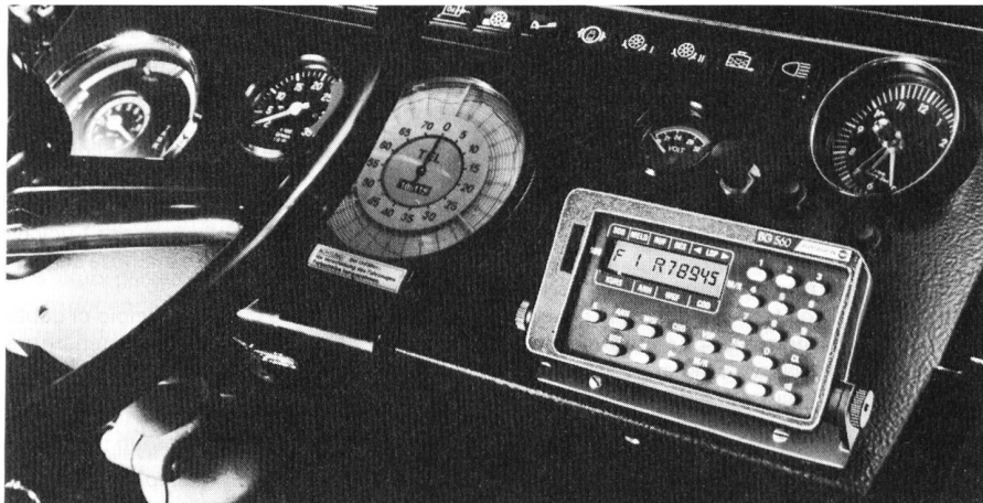
Bild 6 In einem Bus eingebaut, dient hier das Bediengerät BG 560 zur Übermittlung von Fahrzeug- und Verkehrsdaten an die Leitstelle.
