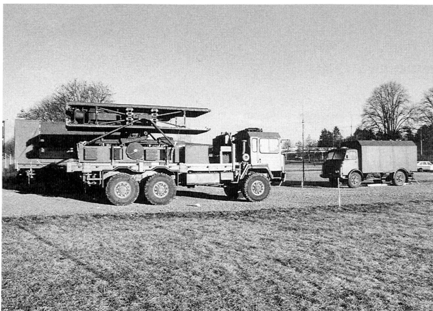
Radarantenne gefaltet in Transportkonfiguration (links), Vermittlerkasten (rechts). Antenne radar pliée en configuration de transport (à gauche), coffre transmetteur (à droite).
