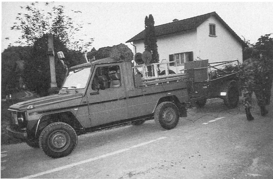
PUCH G Leitungsbaufahrzeug.
