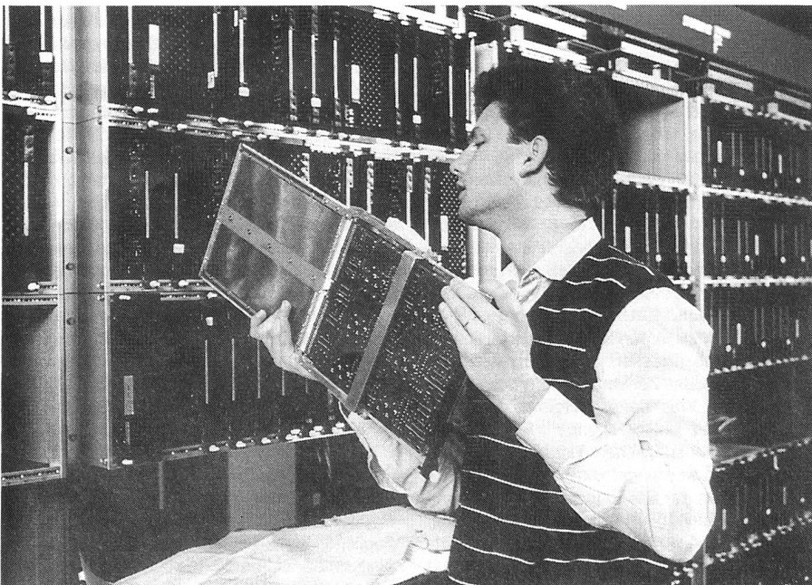
Le système de commutation moderne S12 d'Alcatel STR est prêt pour l'introduction de Swissnet 2. Ainsi, l'automne 1992 fera date dans l'histoire des télécommunications suisses: un seul raccordement permettra à chaque utilisateur de connecter jusqu'à huit appareils terminaux à son choix dont deux pourront fonctionner simultanément, qu'il s'agisse d'un appareil téléphonique, d'un télécopieur, d'un ordinateur personnel, etc.
