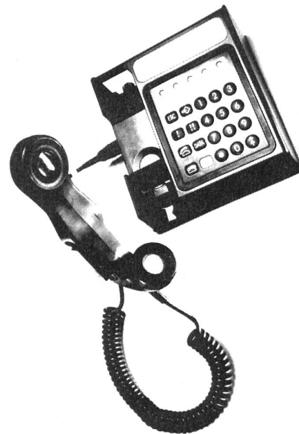
Digitaler Telefonapparat, speziell für IMFS entwickelt
