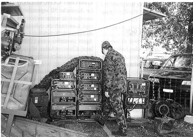
Gerätetürme der R-915
