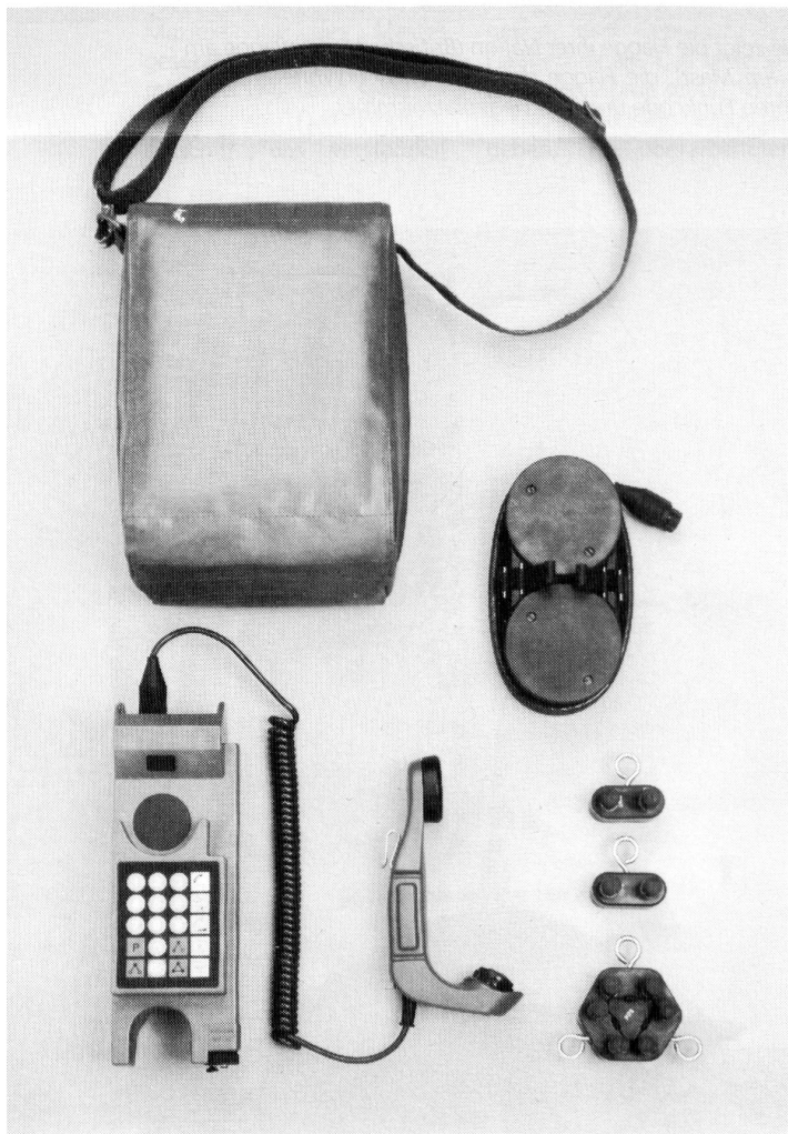
Alle Bestandteile eines AWITEL-Endgerätes: Telefonapparat, Tragetasche, induktive Koppereinheit, Abschlusswiderstände und Abzweigstück.
