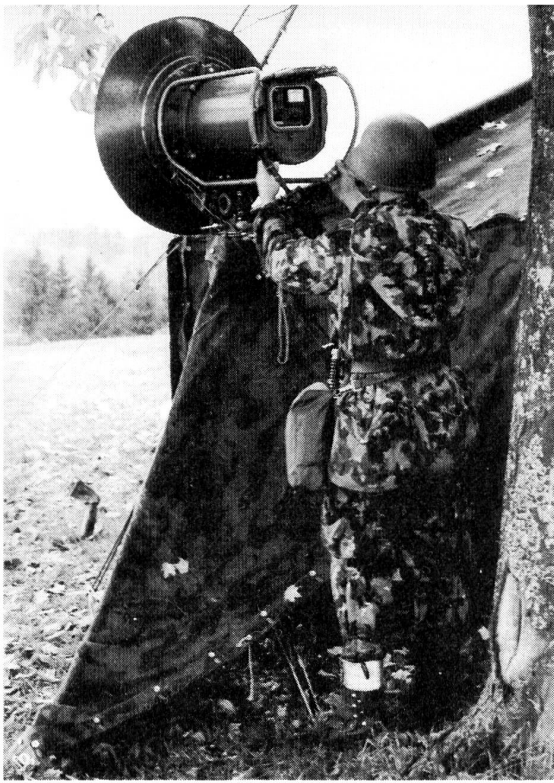
Fast dreissig Jahre im Dienst: das Richtstrahlgerät R-902 soll Anfang des nächsten Jahrtausends vom Nachfolger R-905 abgelöst werden.
