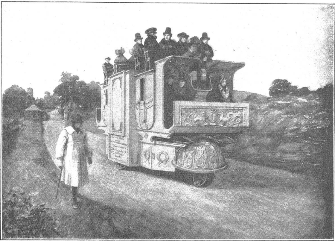
Die Bauart der Dampfstutsche hat sich geändert; sie ist wohl schon zweckentsprechender. Der Erbauer hat aber nicht nur dem Praktischen Rechnung getragen, er hat sein Fuhrwerk auch durch Anbringen von allerlei Zierat wie einen fürstlichen Staatswagen herausgeputzt. Die hier abgebildete Dampfstutsche bot 50 Passagieren bequem Raum; sie verkehrte während mehrerer Jahre zwischen London und Birmingham.
