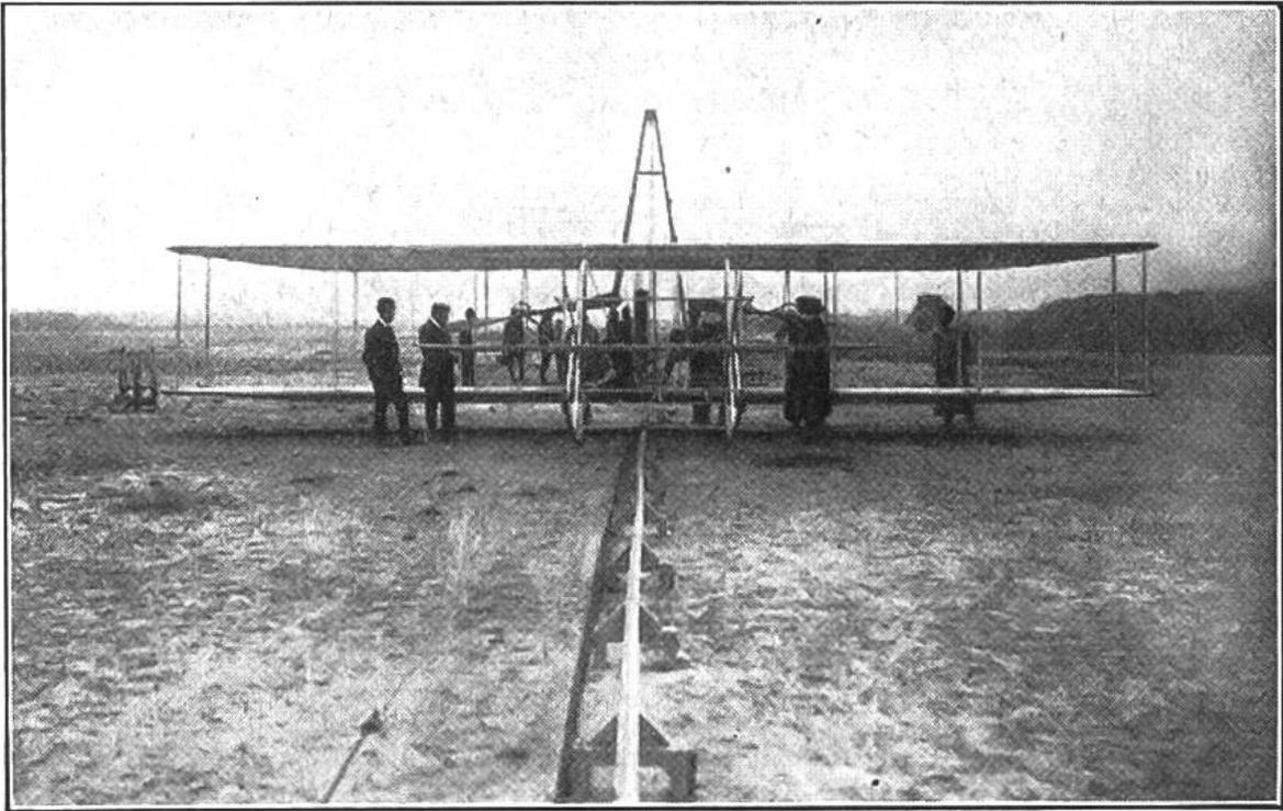
Das Flugzeug der Brüder Wright war ein Doppeldecker, die Steuerung befand sich vorn. Eine besondere Abflugvorrichtung gab dem Apparat, der keine Räder besass, die nötige Fahrgeschwindigkeit, um sich in die Luft erheben zu können.
