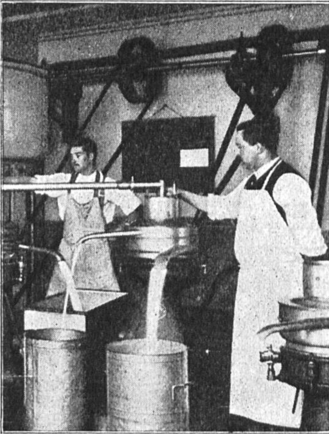
Das Zentrifugieren der Milch. Die frische Milch fliesst in eine Stahltrommel, die sich in der Minute 6500mal dreht, und wird dabei in Rahm und Magermilch getrennt.
