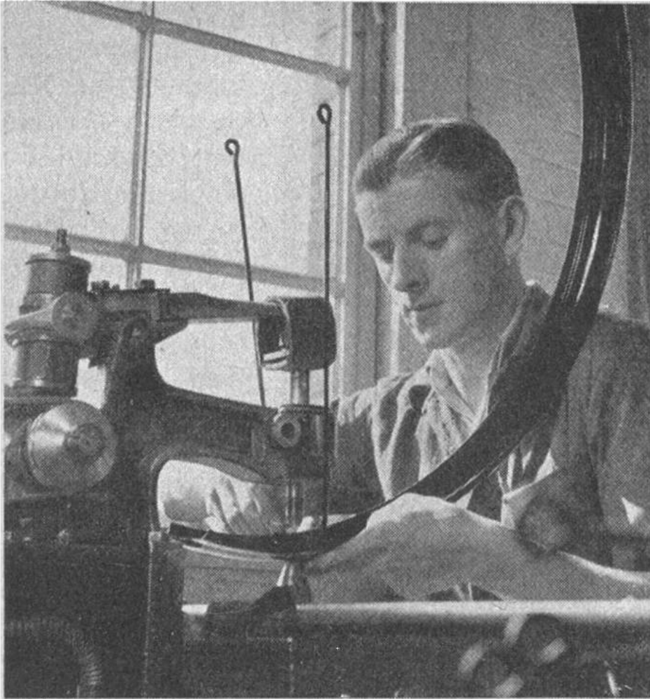
Die Streben der Schutz- bleche wer- den befestigt.
