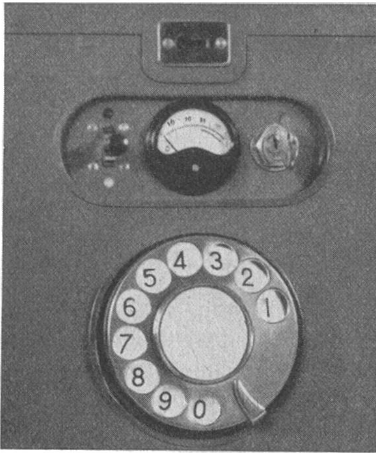
Teil eines Telephon-Apparates für drahtlose Telephonie. Oben: Schalter und Messinstrument zur Kontrolle der Batterien, Schloss zum Abschliessen gegen unbefugte Benützung des Apparates. Unten: Wählscheibe.
