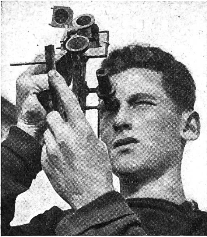
Mit Hilfe des Sextanten muss der künftige Seeoffizier den Standort eines Schiffes bestimmen können.
