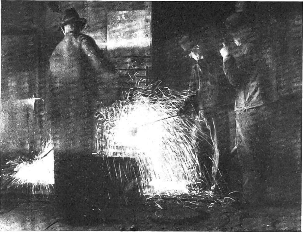
Entnehmen der ersten Giessproben. An der Funkengarbe erkennt der Schmelzer, ob das Eisen für das Giessen bereit ist.
