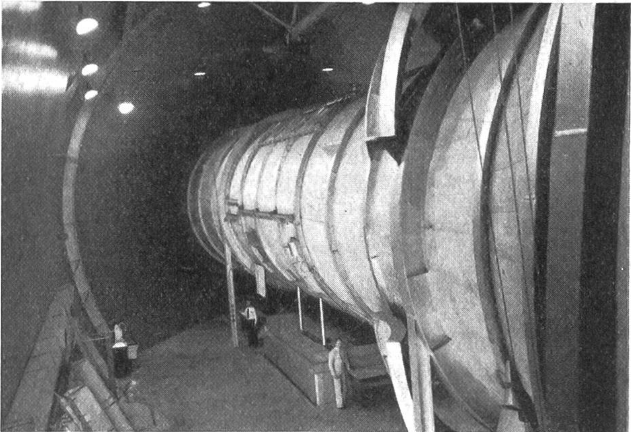
Ansicht eines amerikanischen Windkanals von rund 6 Meter Durchmesser.
