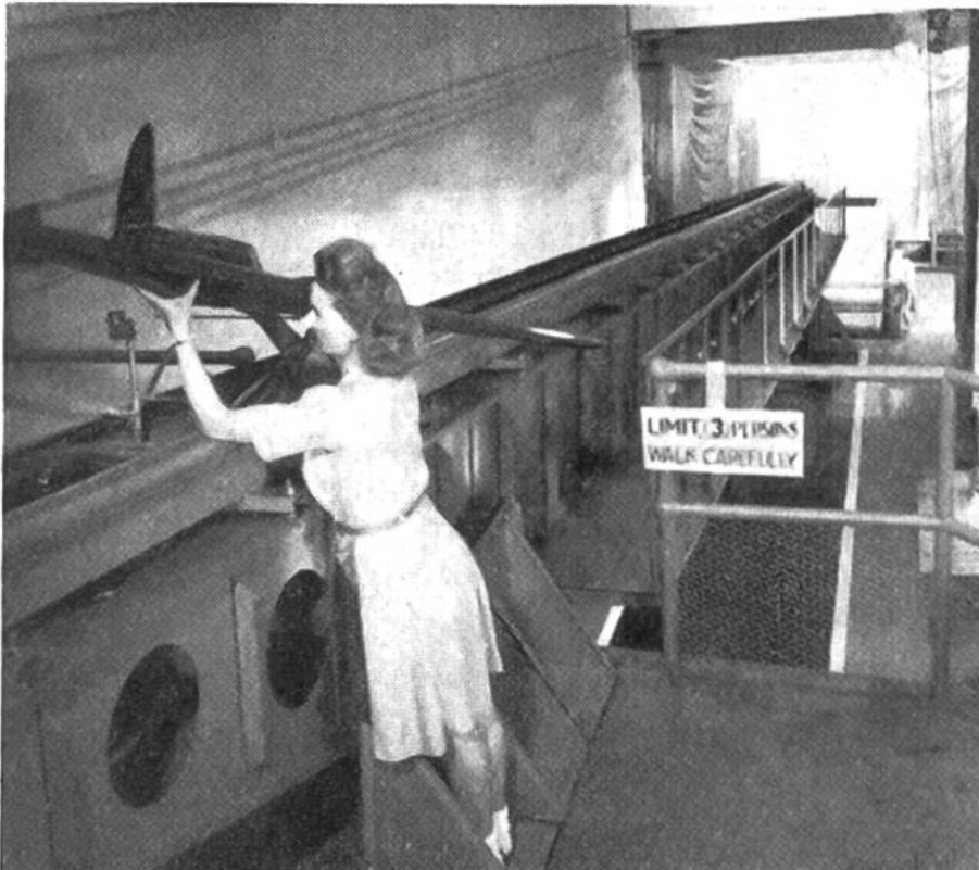
Eine Schleuderbahn, von der aus Flugzeugmodelle auf einen Wassertank geschleudert werden können.
