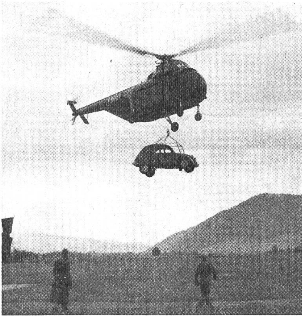
«Fliegender Elefant» wird der 12plätzigte Sikorsky S-55 genannt. Hier sehen wir ihn beim Transport eines Autos. Motor 600 PS. Höchstgeschwindigkeit 176 km/h.
