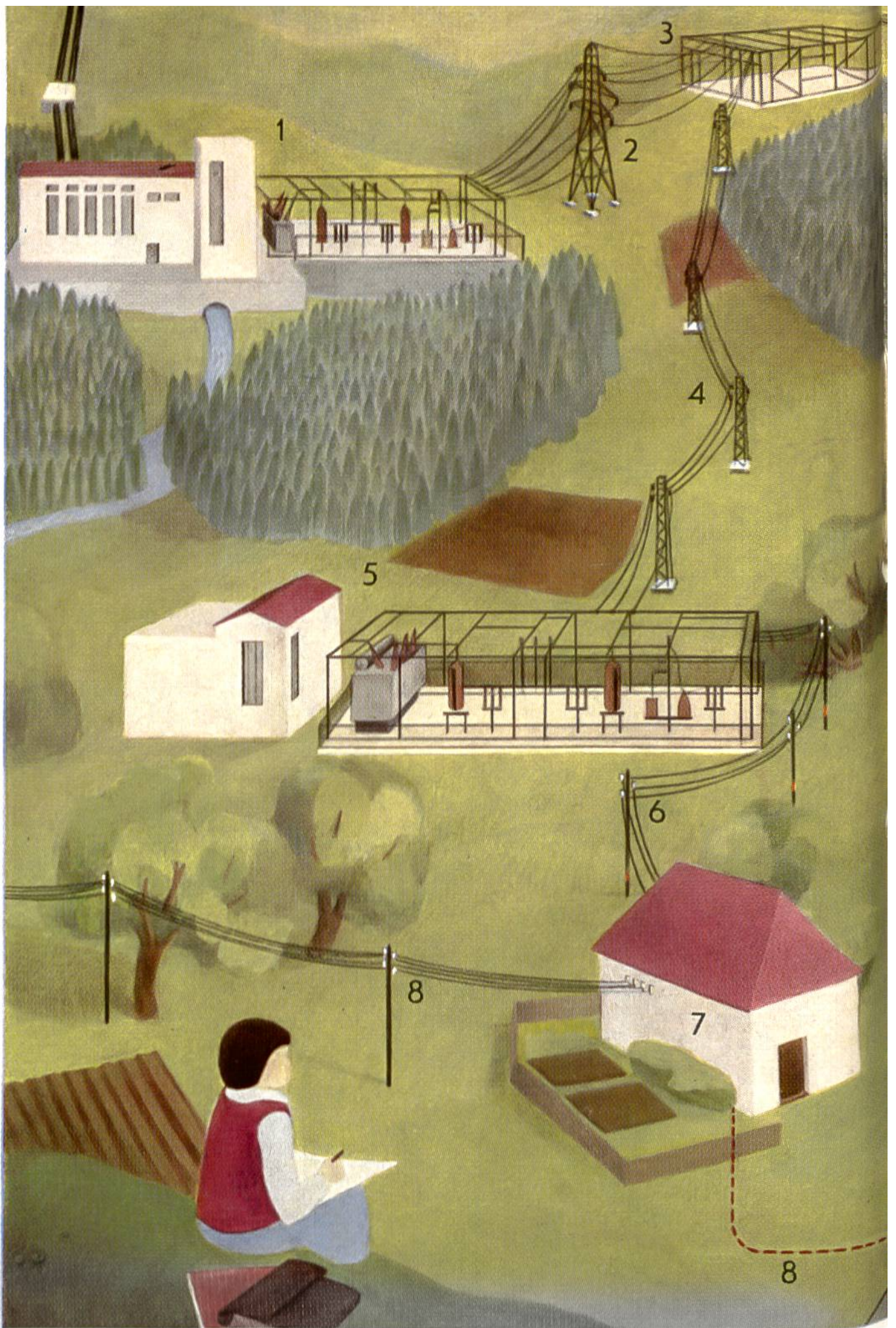
1: Hochdruck-Kraftwerk mit Freiluftanlage; 2: Höchstspannungsfernleitungen; 5: Unterwerk; 6: Hochspannungsleitung; 7: Transf
