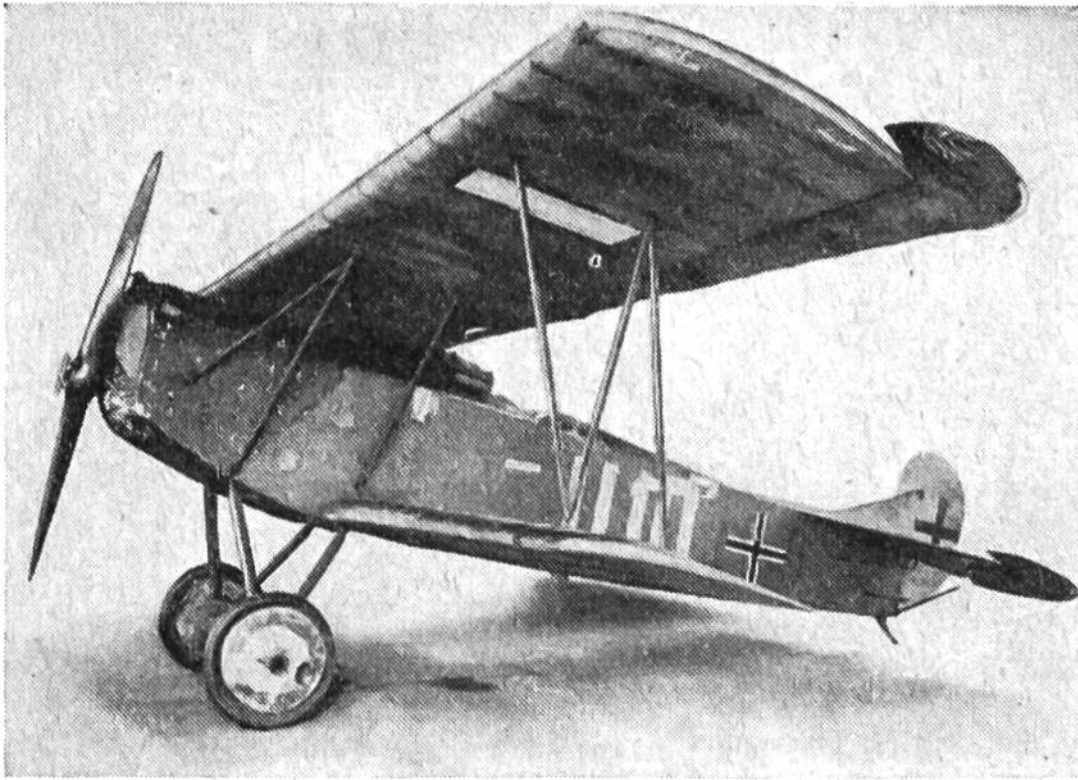
1917: Fokker D-7. Jagdflugzeug aus dem Ersten Weltkrieg. Doppeldecker von 8,9 m Spannweite. 1 Mercedes-Motor mit Flüssigkeitskühlung von 160 PS. Höchstgeschwindigkeit ca. 170 km/h. Bewaffnung: 2 durch den Luftschraubenkreis feuernde Maschinengewehre.
