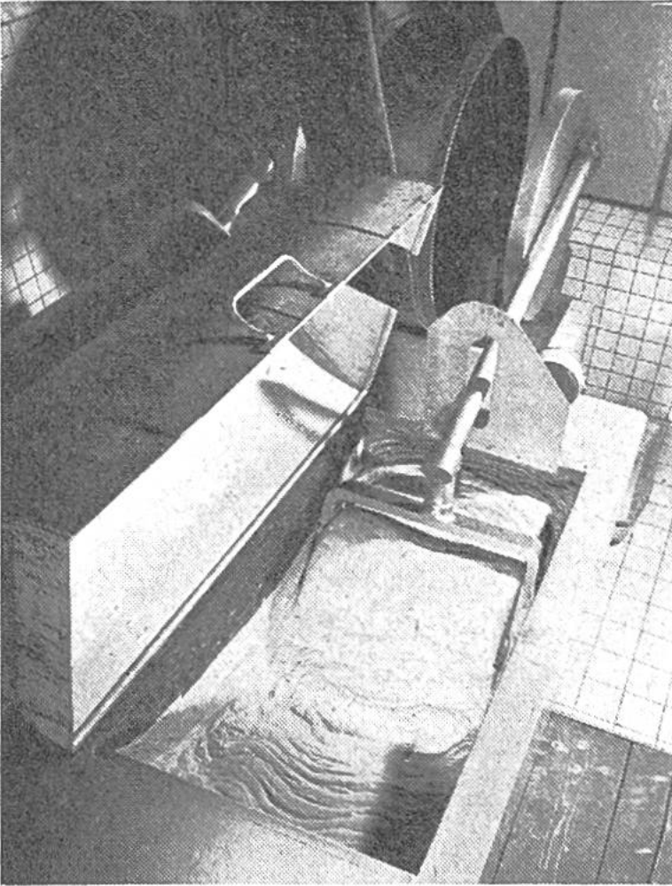
Veredelung der Schokolademasse in der Längsreibemaschine: das grosse Geheimnis der Schweiz!
