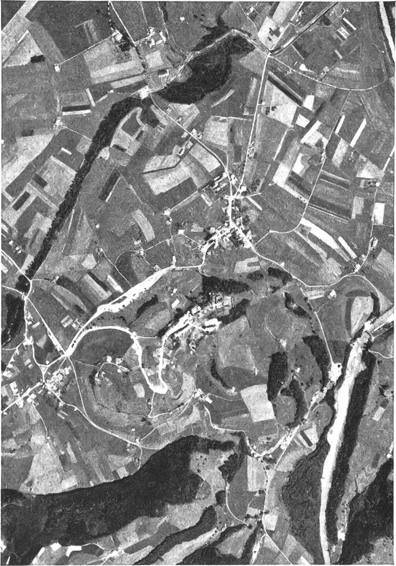
3. Fliegeraufnahme der Eidg. Landestopographie: Flughöhe 6000 m ü/Meer, Wild-Kamera mit Objektiv Aviatar 210 mm. Nebenan: Der gleiche Bildausschnitt auf der Landeskarte.
