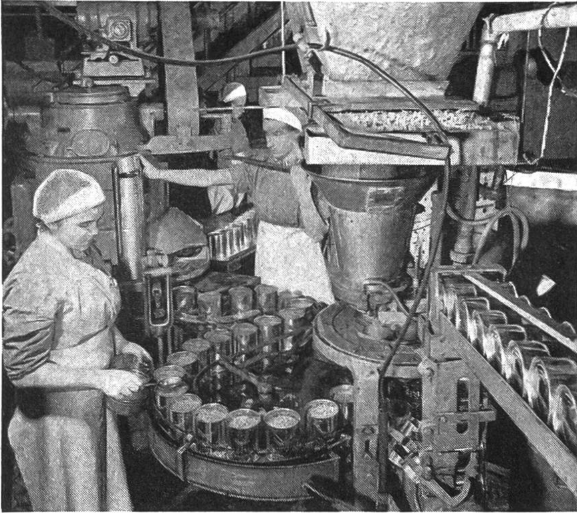
Automatische Abfüll- und Verschlussmaschine für Konservenerbsen. Die leeren Büchsen (von rechts anrollend) werden durch den grossen Trichter mit Erbsen gefüllt und von da zu dem Teil der Maschine geleitet, der ihnen den Deckel aufpresst. So werden pro Minute über 100 Büchsen abgefüllt und verschlossen!
