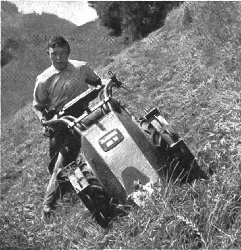
Motormäher mit tiefer Schwerpunktlage am Steilhang. Hier wurde bis vor kurzem mit der Sense gemäht. Der Mann leistet mit dem Motormäher soviel wie 6 kräftige Mäher.
