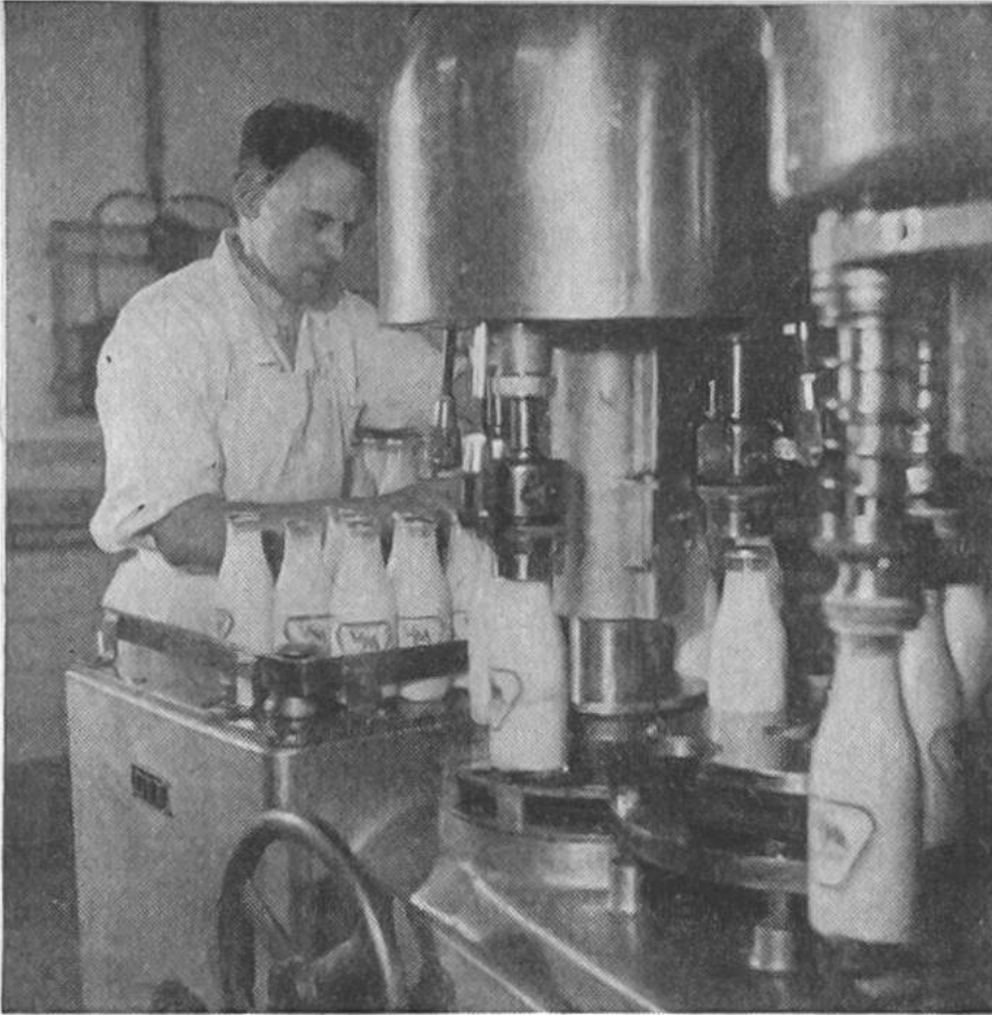
Abfüllmaschine für pasteurisierte Flaschenmilch. Die pasteurisierte Milch wird in grossen Maschinen automatisch in Flaschen abgefüllt.
