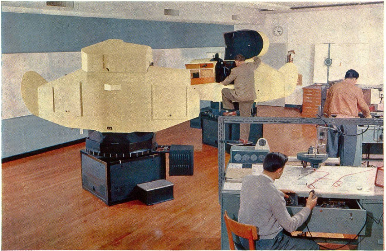
Link-Trainer, Anlage für das Training des Instrumenten- fluges (Blindflug).
