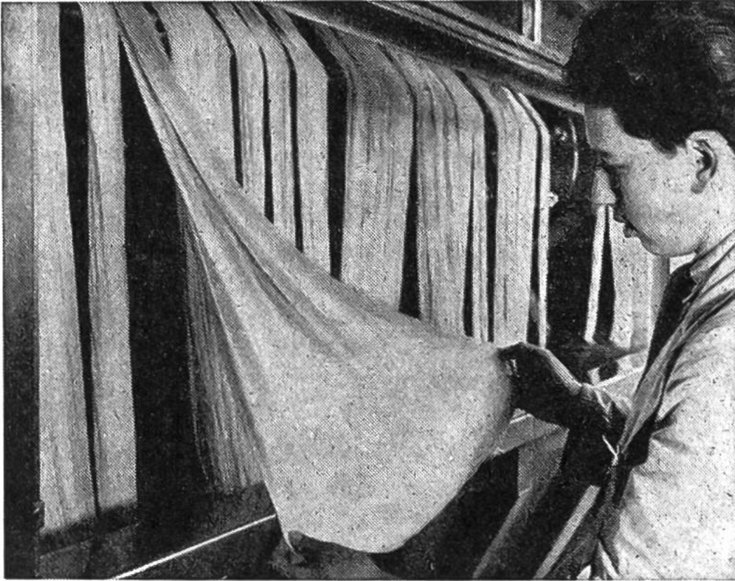
Farbton und Egalität von Trikotstoffen werden auch während des Färbens auf der Maschine laufend überprüft.
