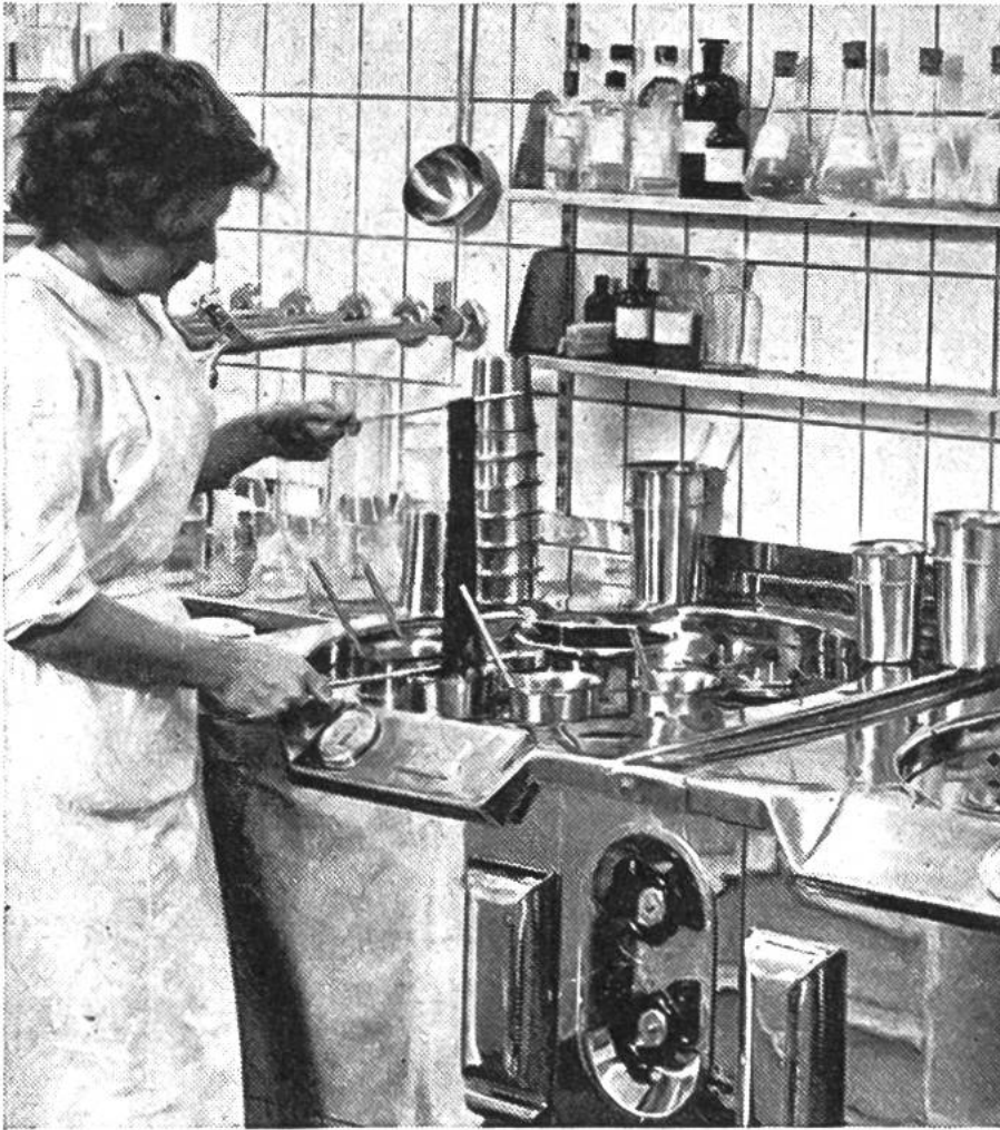
Im Laboratorium einer modernen Grossfärberei werden die Färberezepte an kleinen Musterstrangen ausgearbeitet.
