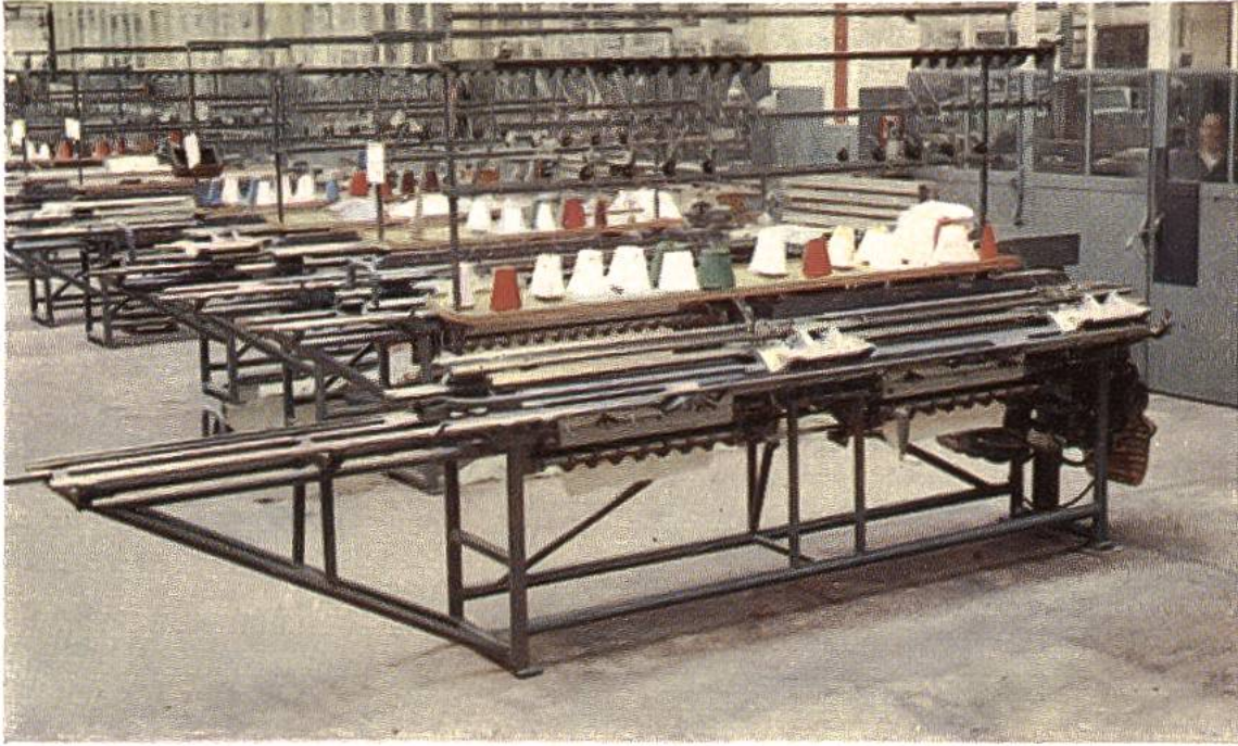
Die Schlusskontrolle der automatischen Flachstrickmaschinen. Im Vordergrund sind deutlich die beiden Schlitten einer «zweiköpfigen» Maschine ersichtlich.
