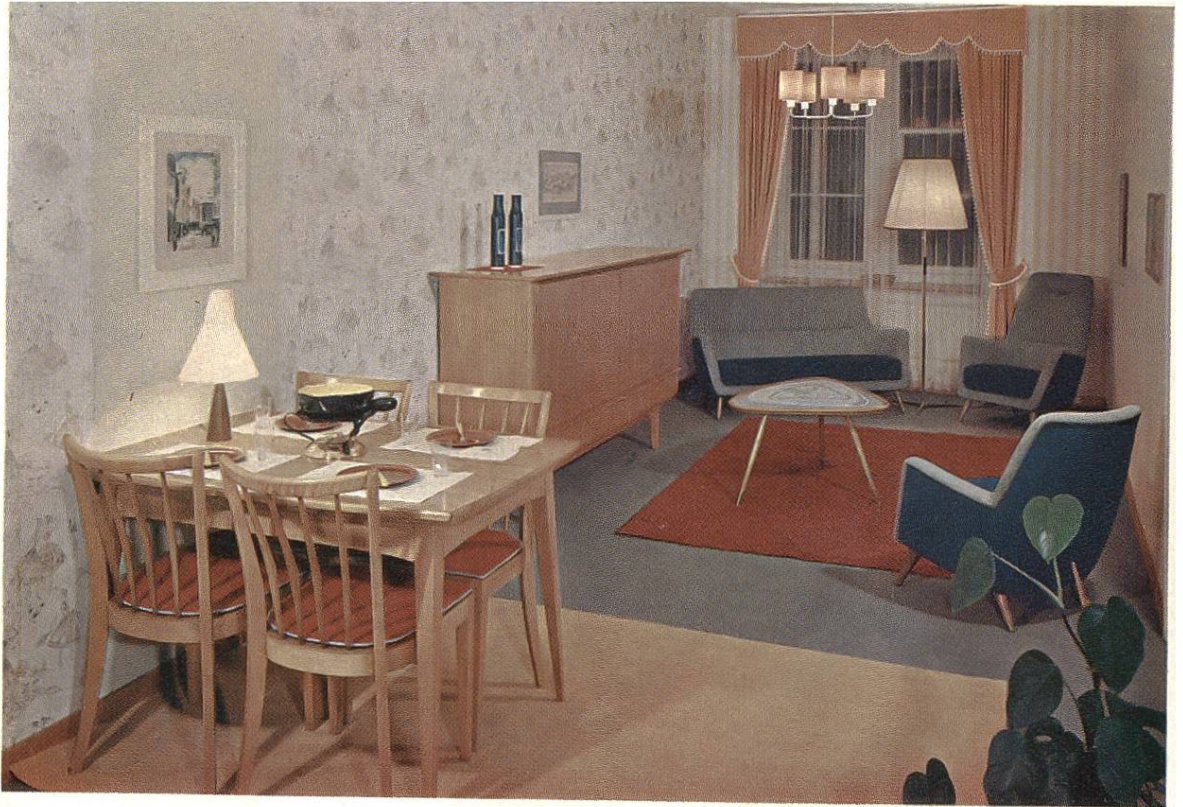
Zweckmässige moderne Wohnraumbelichtung, bestehend aus einem Leuchter für die Allgemeinbeleuchtung, einer Ständerlampe als Leselampe und einer Tischlampe als Arbeitsplatzleuchte. (Aufnahme bei B. Biasiutti, Zürich.)
