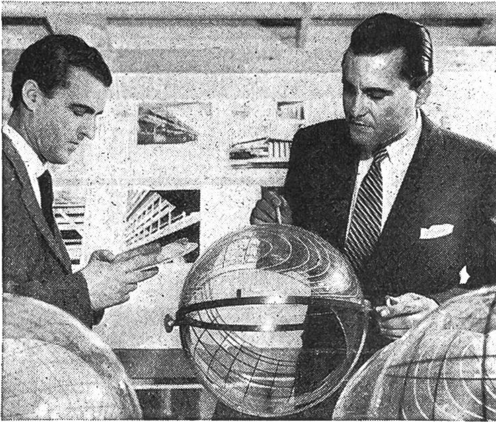
Diese amerikanischen Architekten benützen einen Sonnenstandsmesser, der die Sonnendauer für jeden beliebigen Punkt während jeder Jahreszeit angibt.
