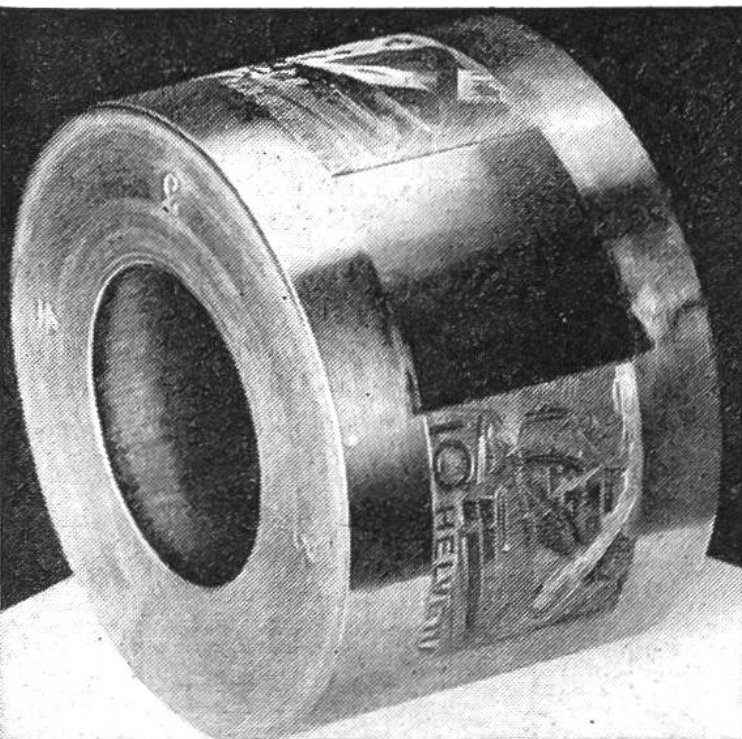
Molette. Das Markenbild ist vom Stahlstich auf den Molettenring übertragen.
