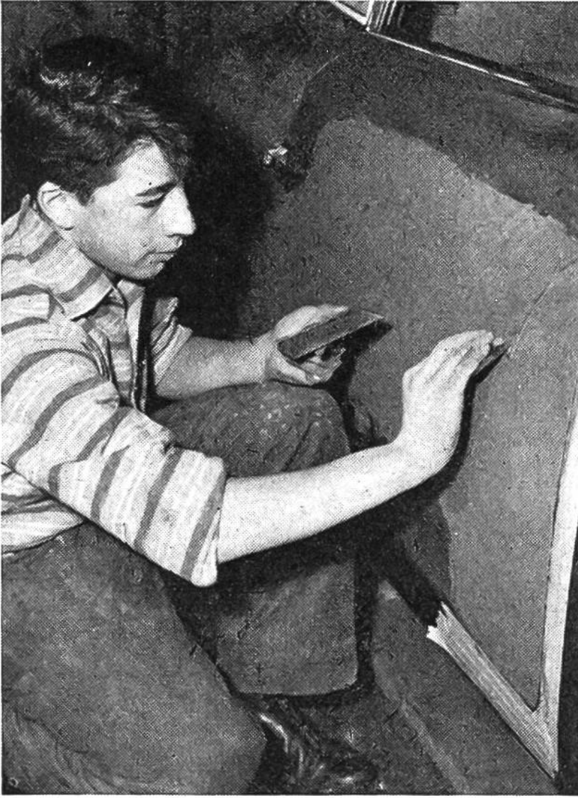
Der Autolackierer bereitet durch das Spachteln die Lackierung vor.
