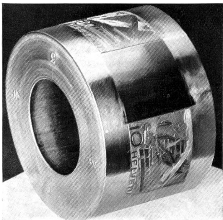
Rulletto. - L'immagine del francobollo è riportata dalla lastra d'acciaio sul rulletto.
