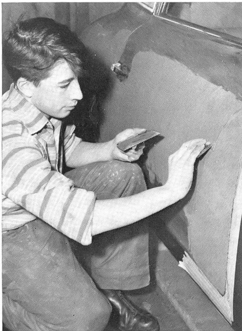
Ragazzo intento ad applicare la vernice, a mezzo di una spatola, sulla portiera di una automobile.
